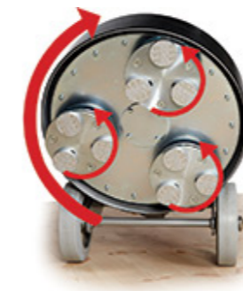
Figur 41 Illustrerar sliphuvudernas rotation i förhållande till växelhuset.
