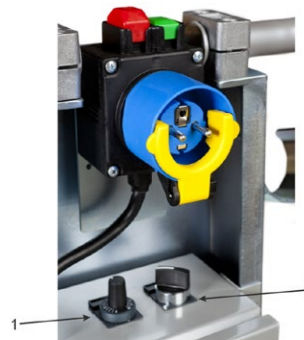
Figur 43 Kontrollpanel för Scanmaskin 18
