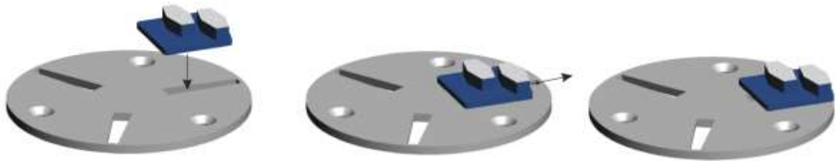
Figur 4-4 Hvordan man fæster slibesegmenterne på Scan-On-fæsteskiven
